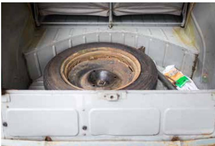
Le fond de coffre est garni d'origine de deux lattes en bois vissées au châssis. Elles permettent d'installer la roue de secours à l'envers sans en rayer la peinture. On peut ainsi ranger quelques affaires dans la roue, et gagner un peu de place de chargement.
