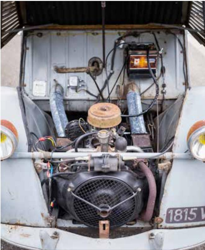
Sous le capot, toute la mécanique a été intégralement révisée pour la remise en route. Le moteur dont le type est AZU a été changé à une époque (d'où la présence anachronique des boîtiers de chauffage) mais pour le reste tout est d'origine: embrayage centrifuge et carburateur à frein de ralenti à membrane compris!
