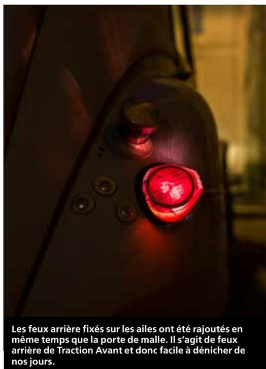
Les feux arrière fixés sur les ailes ont été rajoutés en même temps que la porte de malle. Il s'agit de feux arrière de Traction Avant et donc facile à dénicher de nos jours.
