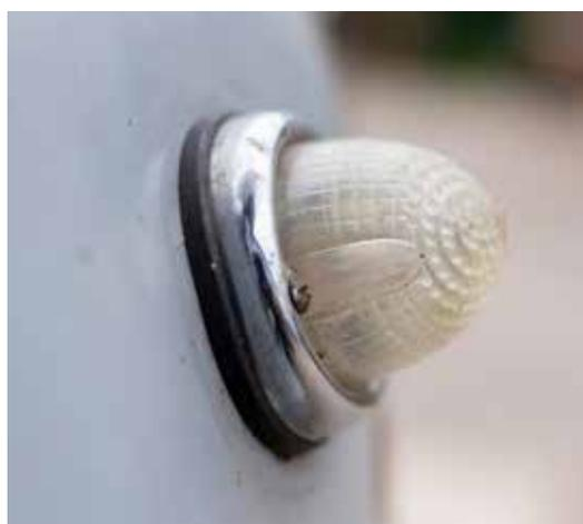
Les petits clignotants ronds étaient une spécificité pour la Suisse et selon les époques pour l'Allemagne également. Les autres 2 CV assemblées en Belgique, dans l'usine Citroën de Forest ne possédaient pas de clignotant sur les ailes avant.
