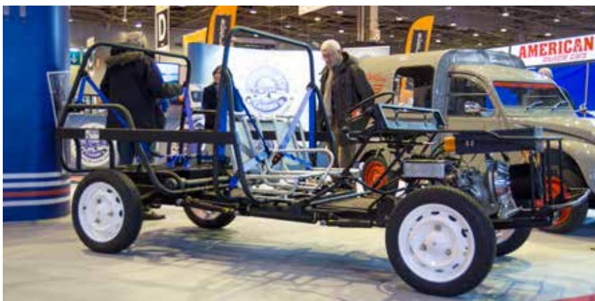
Une EDen dépourvue de sa carrosserie montrait son architecture, son arceau arrière et ses solutions techniques un peu différentes de celles employées sur l'E-Story, essayée dans les pages du n° 112 de Planète 2 CV.
